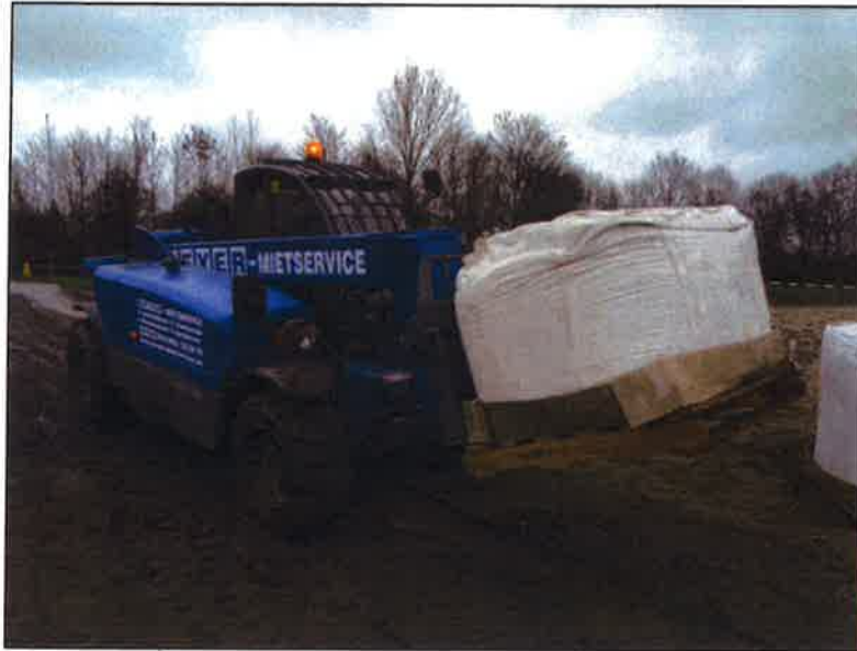
Fot. 3. Ładowarka w czasie transportu „Big Bagu” z preparatem, widać gumowe wzmocnienie trasy dojazdu nad brzeg jeziora
