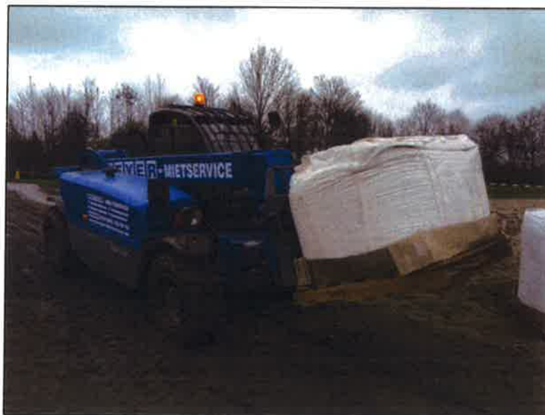
Fot. 3. Ładowarka w czasie transportu „Big Bagu” z preparatem, widać gumowe wzmocnienie trasy dojazdu nad brzeg jeziora
